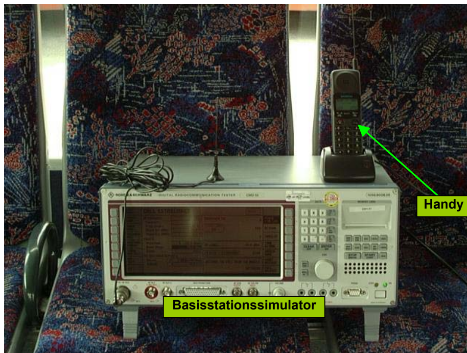
Abb. 11: Basisstationssimulator CMD 55 mit Testhandy Siemens S4
